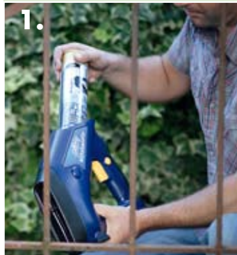
1. Den Farbkanister in die batteriebetriebene Farbepistole einsetzen, ...
