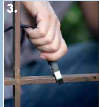
3. ... das Erdungskabel an das Metallobjekt clippen ...
