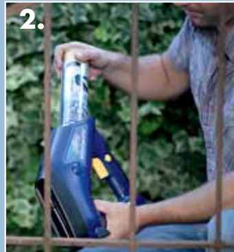
2. ... den Farbkanister in die batteriebetriebene Farbpistole einsetzen,
